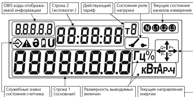
Рисунок 4.4 – Вид дисплея счетчика и устройства
