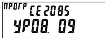
Рисунок 4.1 – Кадр с типом подключенного измерительного блока и качеством сигнала связи
