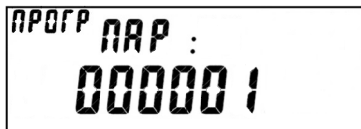
Рисунок 4.3 – Кадр с паролем доступа подключенного измерительного блока
