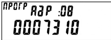
Рисунок 4.2 – Кадр с адресом подключенного измерительного блока
