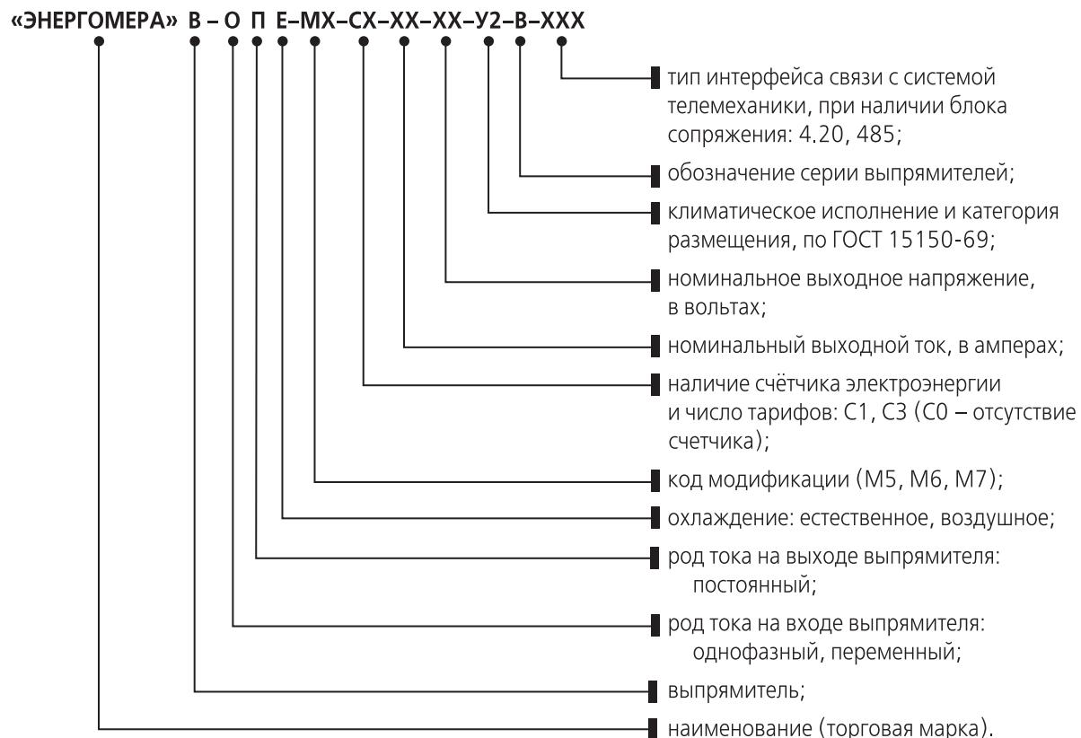
**Пример записи условного обозначения выпрямителя при его заказе или в проектной документации :**
