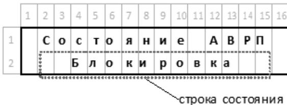
Рисунок Д.7 – Структура информационного экрана «Состояние АВРП»
