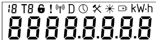
Рисунок 7.1 – Общий вид ЖКИ счетчика в режиме теста
