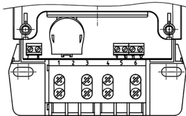
Рисунок 1.3 – Нумерация контактов счетчика СЕ208 S7
