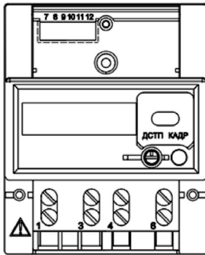
Рисунок 1.4 – Нумерация контактов счетчика CE208 R5
