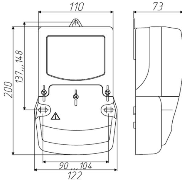
Габаритные размеры счетчика СЕ208 Р5
