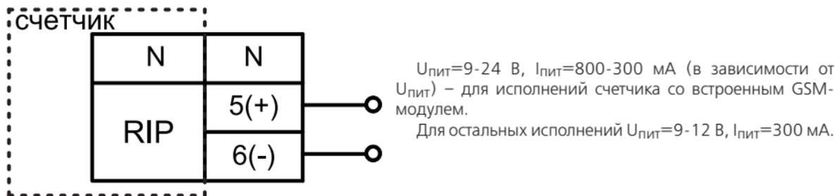
Рисунок 3.12 – Схема подключения РИП
