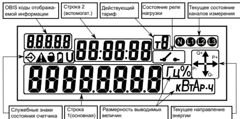
Рисунок 5 – Внешний вид ЖК индикатора устройства СЕ901
