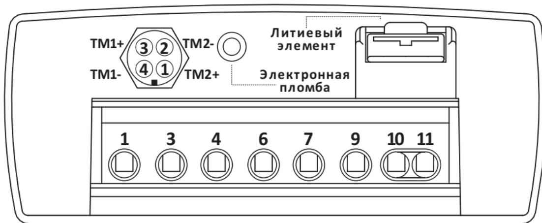
Рисунок 3 – Обозначение контактов счетчика без модулей GSM / NB-IoT
