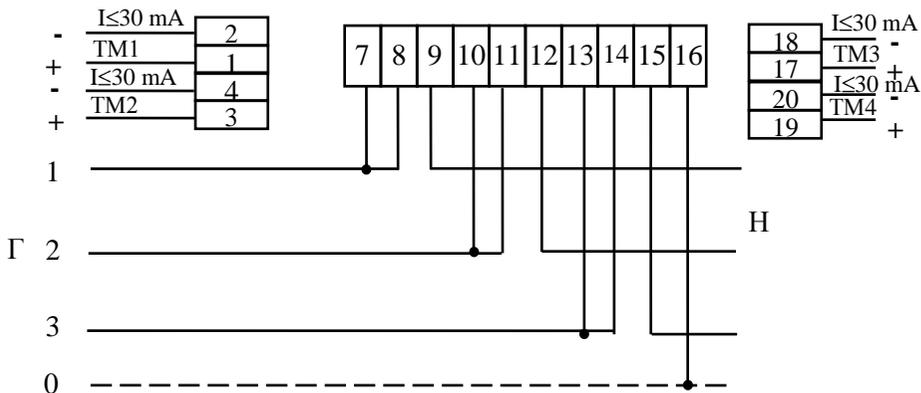
Примечание – Перемычки между контактами 7-8, 10-11, 13-14 расположены на колодке.
