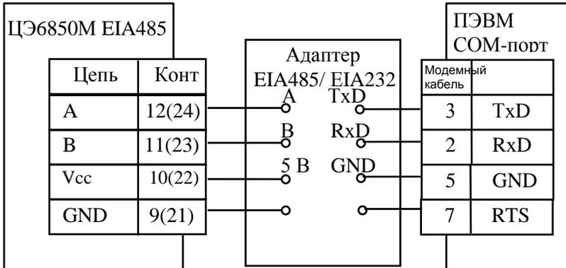
Примечание – в скобках обозначены контакты для исполнений счетчиков 5-100А, без скобок – для остальных исполнений
