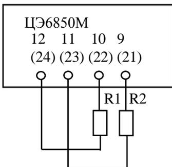
Рисунок 4.4- Схема подключения резисторов растяжки
