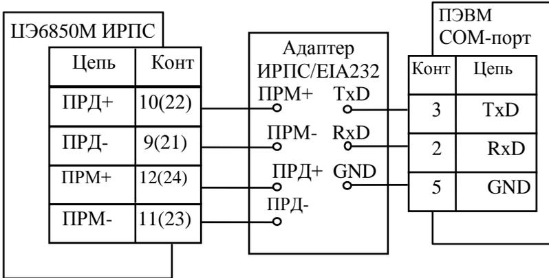
Примечание – в скобках обозначены контакты для исполнений счетчиков 5-100А, без скобок – для остальных исполнений
