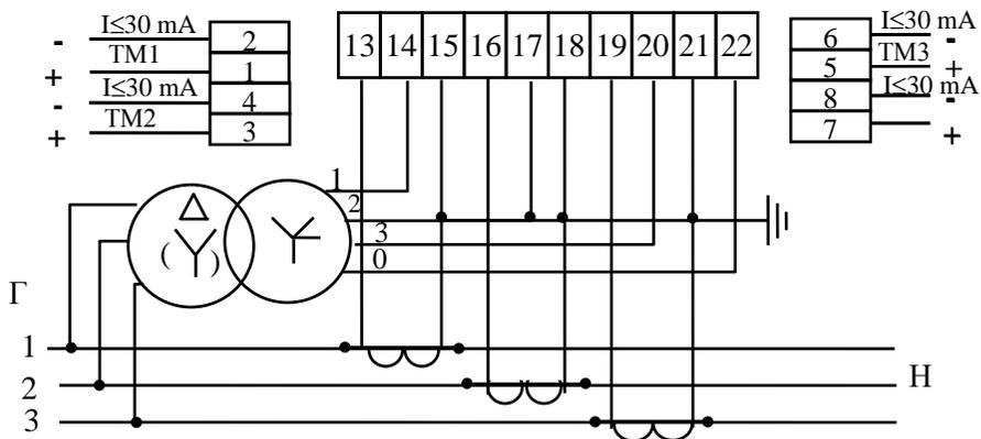
**Схема включения счетчиков с двумя
