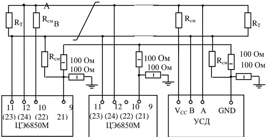
$R_{CM}$  – 560 Ом, резисторы смещения установлены в счетчике. Для их подключения необходимо соединить контакты 4 – 6 и 3 – 1 X30 на нескольких счетчиках в зависимости от уровня помех на линии.
