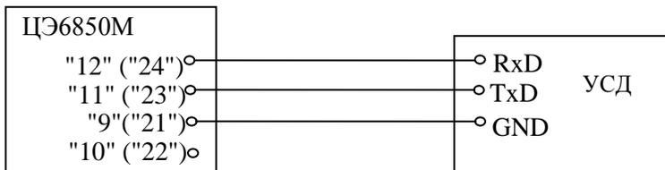
Рисунок 4.5 - Схема подключения интерфейсных линий EIA232
