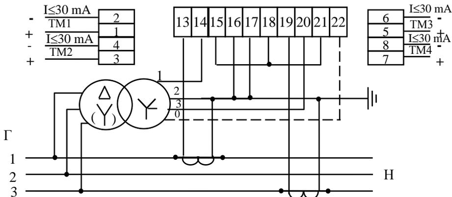
Примечание – В трехпроводных сетях "нулевой" провод к зажиму 22 допускается не подключать.
