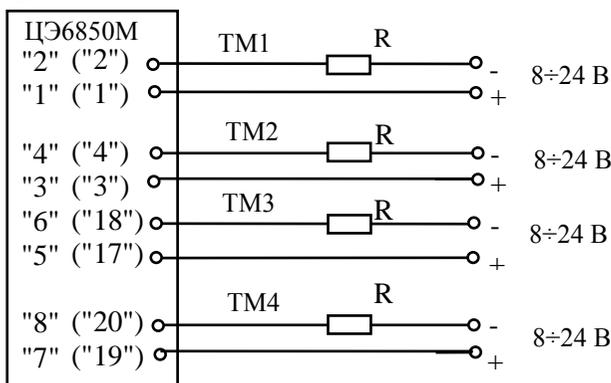
Рисунок 4.1 - Схема подключения импульсных выходов
