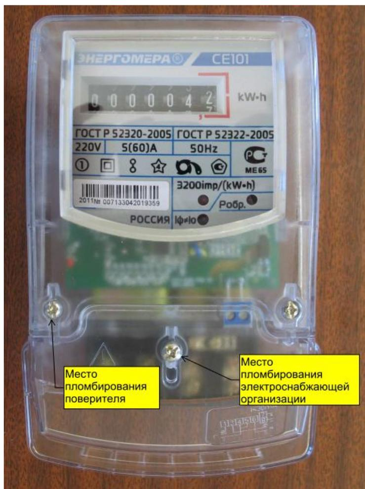
Рисунок 4 – Общий вид счетчика CE 101 S4
