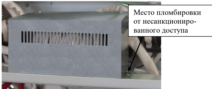
Рисунок 3 – Место пломбировки встроенных пассивных изолирующих трансформаторов тока
