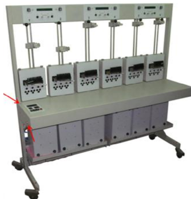
Рисунок 6 - Общий вид стенов установок исполнений ЦУ6800/1-Т6, ЦУ6800И/1-Т6, ЦУ6800/2-Т12, ЦУ6800И/2-Т12, ЦУ6800М/1-Т6, ЦУ6800МИ/1-Т6, ЦУ6800М/2-Т12, ЦУ6800МИ/2-Т12 и места пломбирования модуля вычисления
