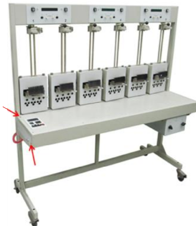
Рисунок 5 - Общий вид стенов установок исполнений ЦУ6800-Р, ЦУ6800И-Р, ЦУ6800М-Р, ЦУ6800МИ-Р и места пломбирования модуля вычисления
