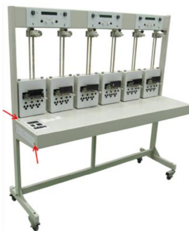
Рисунок 4 - Общий вид стенов установок исполнений ЦУ6800-О, ЦУ6800И, ЦУ6800М, ЦУ6800МИ и места пломбирования модуля вычисления
