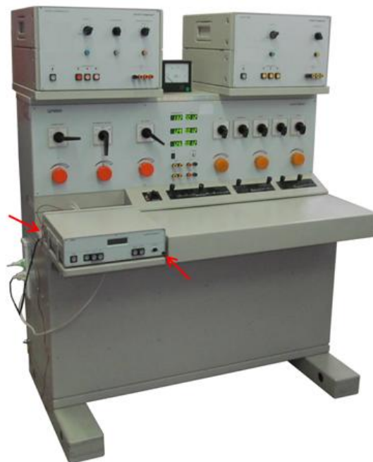
Рисунок 2 – Общий вид пульта установок исполнений ЦУ6800-О, ЦУ6800-Р, ЦУ6800И, ЦУ6800И-Р, ЦУ6800-Т, ЦУ6800И-Т и места пломбирования эталонного счетчика ЦЭ6806-0,1.
