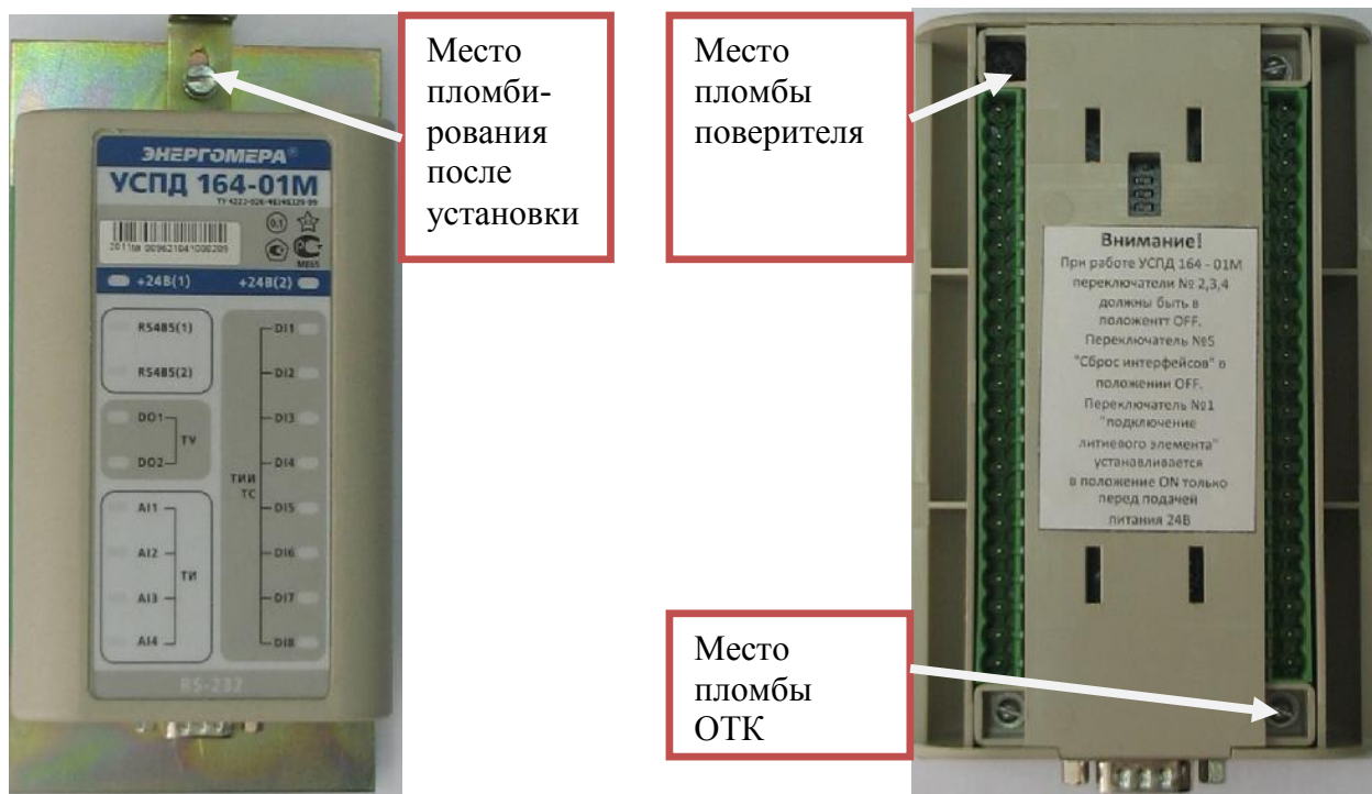
Рисунок 1 – Общий вид УСПД и места пломбирования
