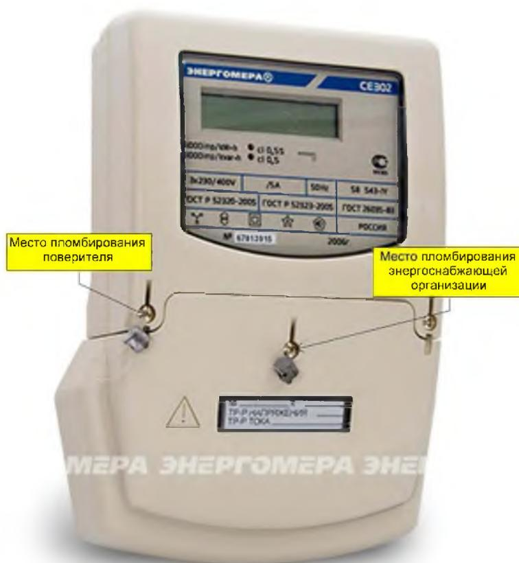
Рисунок 2 – Общий вид счетчика CE302 S33
