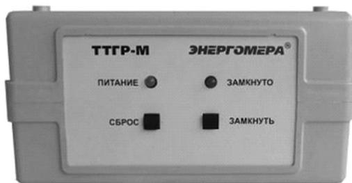
Рисунок 2.1 – Вид ТТГР-МА со стороны передней панели
