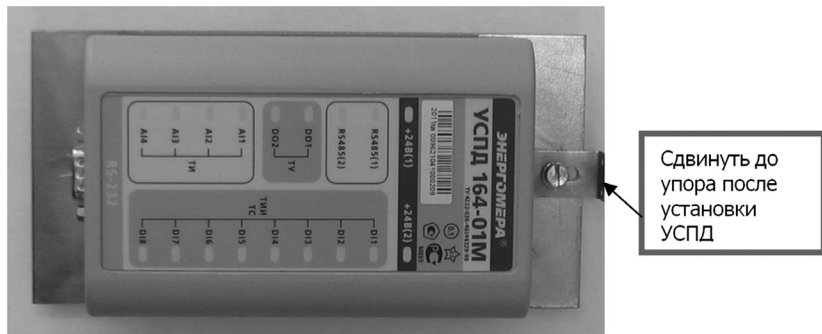
Рисунок 2 – УСПД, установленное на колодку
