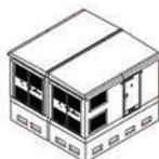
Блочная комплектная трансформаторная подстанция в железобетонном объёмном корпусе, общим коридором обслуживания и выкаткой трансформаторов в одну сторону напряжением 10(6)\0,4 кВ с двумя трансформаторами мощностью: 2х160; 2х250; 2х400; 2х630; 2х1000 кВА.
